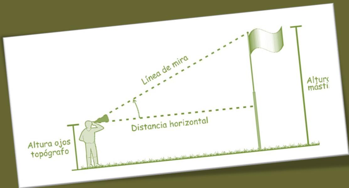
Para realizar el cálculo dibujamos en nuestro cuaderno de campaña un croquis del triángulo rectángulo que estamos resolviendo, anotando la distancia horizontal, el ángulo, la altura de los ojos del topógrafo observador etc.
